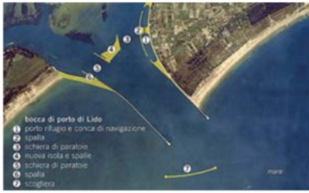
La piantina Lo schema spiega la collocazione delle paratoie alla bocca di porto del Lido di Venezia. Ci sono anche a Malamocco e Chioggia
