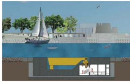
Il rendering Una paratoia nella posizione di riposo, quando non suona l'allarme per l'alta marea: è adagiata nel cassone sul fondo della laguna
